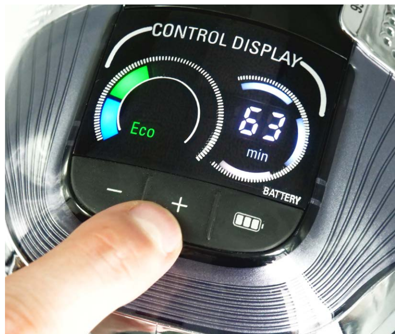
Mittels der unter den Liquid Crystal Displays zu sehenden Tasten kann man bspw. den aktuellen Modus des Modells verändern. Deren Mechanik ist solide, vermittelt während des Tastendrucks aber keinen wirklich erheblichen Widerstand.
