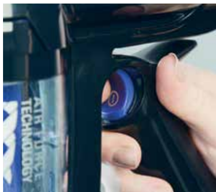
Der leicht erreichbare Betriebsschalter muss im Betrieb nicht dauerhaft betätigt werden; ein einmaliger Druck genügt.
