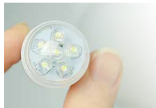
Die LED lassen sich ohne weiteres auswechseln.
